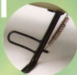
AUTOMATISCH EINKLAPPBARER SEITENSTA
